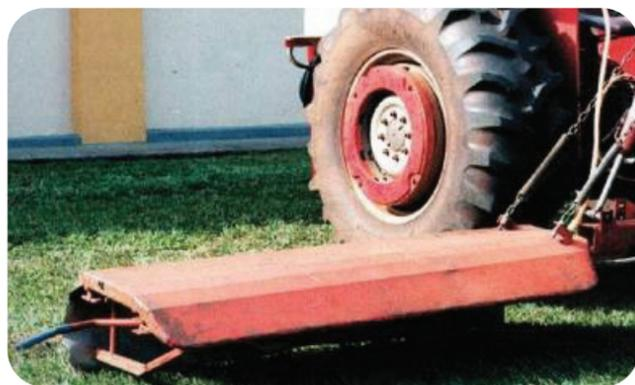
Figura 3. Barra lateral ou barra Bentley para aplicação de herbicidas em frutíferas arbóreas.
