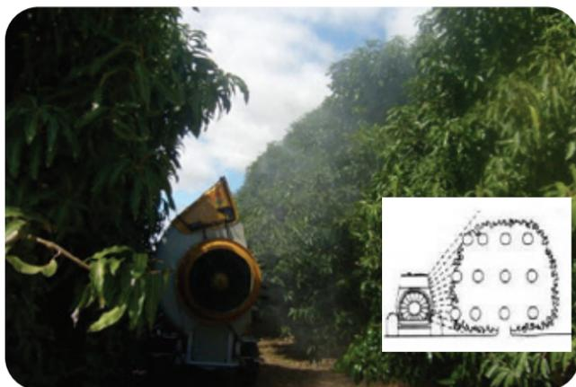
Figura 1. Aspectos do direcionamento dos jatos de pulverização. Acima, equipamento distante de plantas de uvas. Abaixo, jato de calda transpondo tangencialmente a copa das plantas evidenciando risco de deriva na aplicação. Fonte: o autor.
